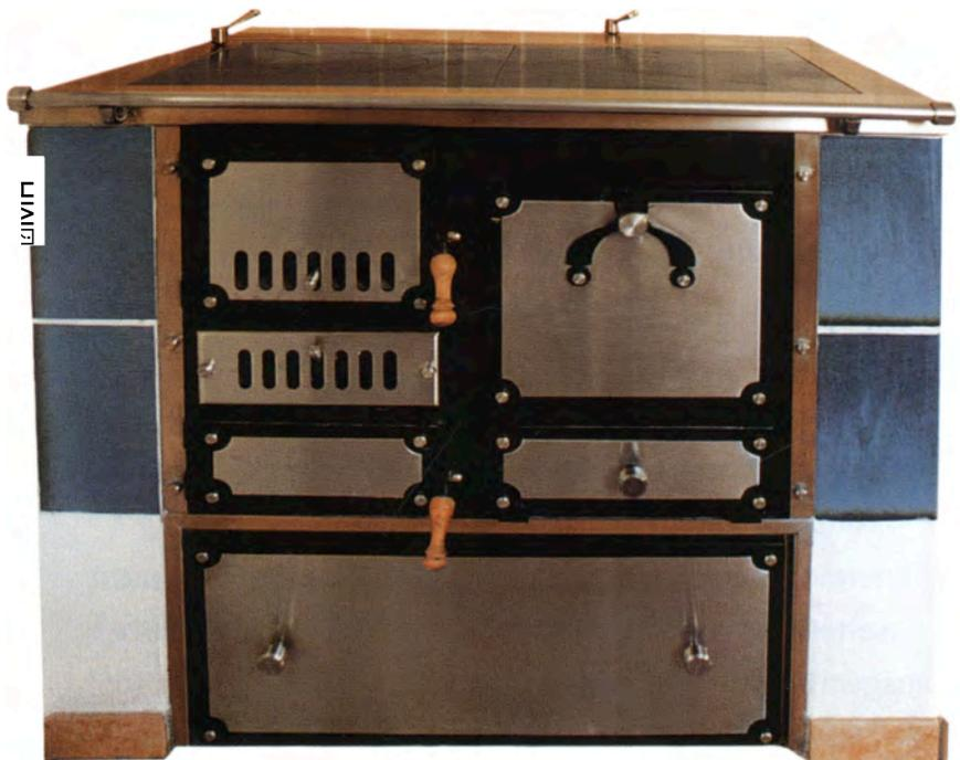
*Nostalgischer Nachbau mit Rostfeuerung, Aschekasten und Herdstange; Umstellhebel für Rauchgaswege um das Backrohr oder in den Warmluftofen.*
