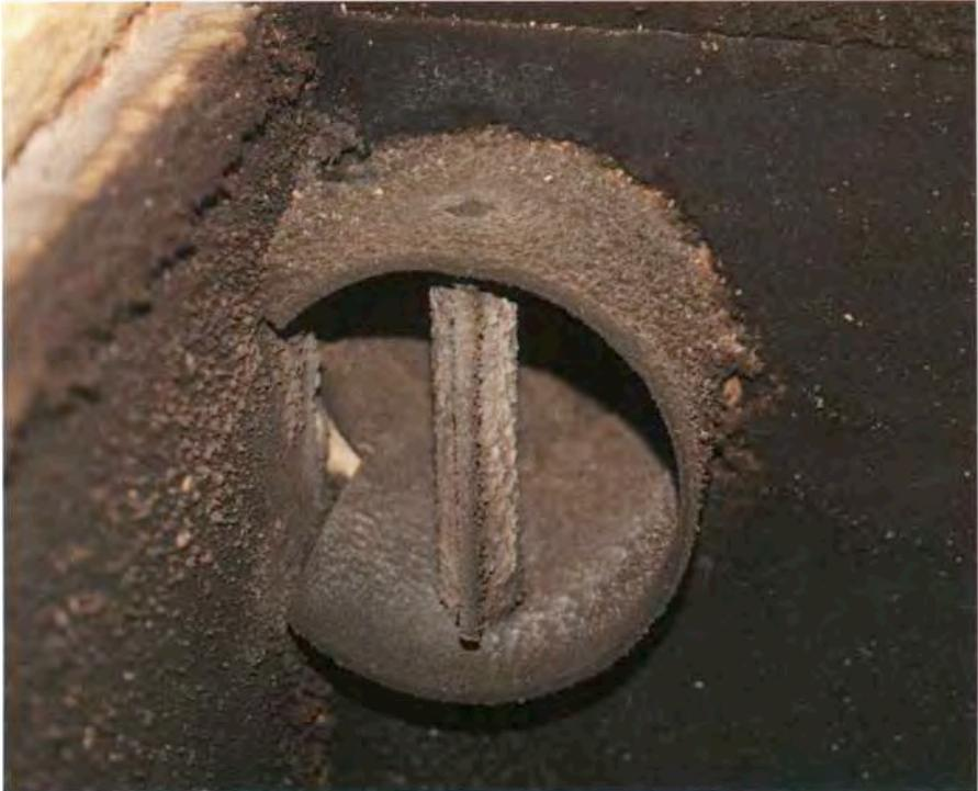
*Das Innere eines Holzofens ist schwärzer als Kaffeesatz, hat aber trotzdem deutliche Aussagekraft: Flugasche auf dem Rohrstutzen von schnellen Anheizfeuern, Rußflocken an der Ofenwand links von Nadelholz und ein Ansatz von Glanzruß nicht ganz ausgetrockneter Buchenscheite. „Stimmt alles!“, sagte der Heizer. (FAE)*
