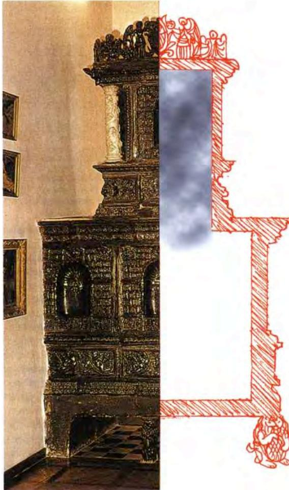
*Zu Zeitbomben geraten nicht nur mit explosivem Holzgas gefüllte Hohlräume, wie Aufsätze, Züge etc., sondern alle Öfen, deren Feuer mit Luftklappen oder Rauchgasdrosselklappen abgewürgt werden.*
