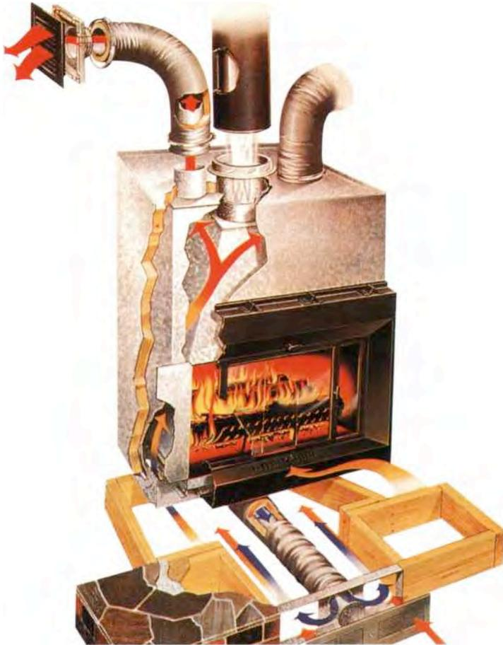
*Die Pfeile auf dieser Zeichnung eines luftheizenden Kaminofens zeigen, was die „Luftheizungsbauer“ von der Luft verlangen, wo sie hinein, herum und heraus strömen soll. Bei Teillast zieht wenig Luft durch die Gitter und Kammern, lagert dabei Staub ab, der bei voller Leistung wieder ausgeblasen wird.*
